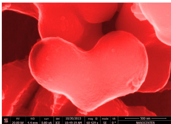
Slika 2: Vzorec TiO 2 nanodelcev, ki so bili sintetizirani s hidrotermalno sitezo.
